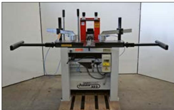
**Rahmendübel- und Langlochbohrmaschine
