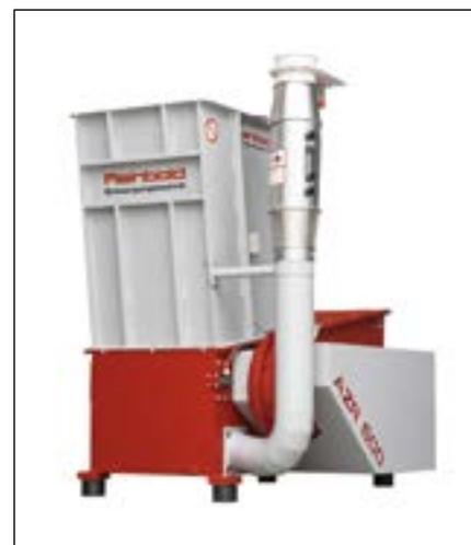
**Einwellenzerkleinerer Reinbold AZR 600 mit Rohrmagnet**
