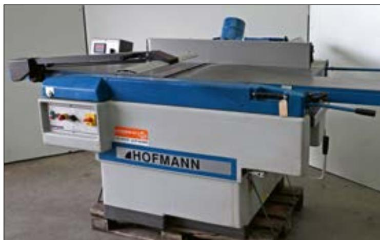
**Abricht-Dickenhobelmaschine Hofmann AD 514**
