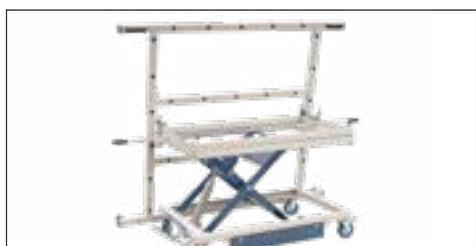
**Niveau Arbeits- und Montagetisch Beck HS 300 midi Schwenk-max mit Plattformschwenkrahmen, vertikal gestellt**
