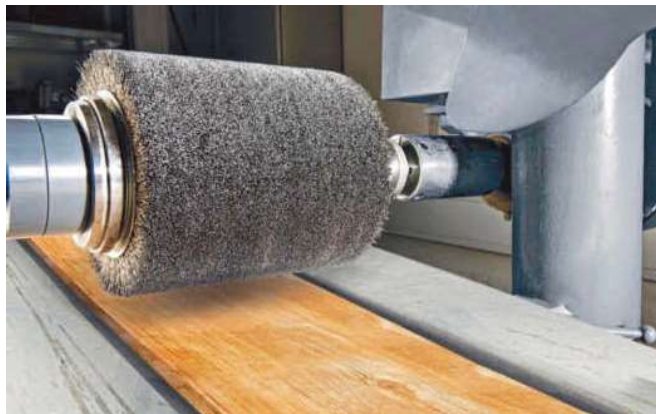
/ Hier bewährt sich eine Walzenbürste von Kullen-Koti beim Flächenschleifen von Holzpaneelen für den Möbelbau.
