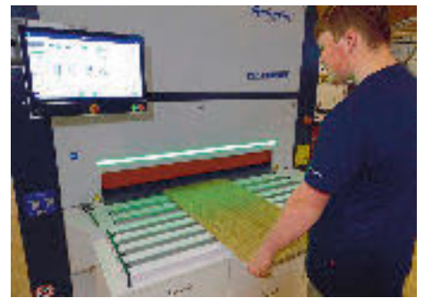
Neben Holz und Holzwerkstoffen wird auf der Heesemann auch Mineralwerkstoff geschliffen.
